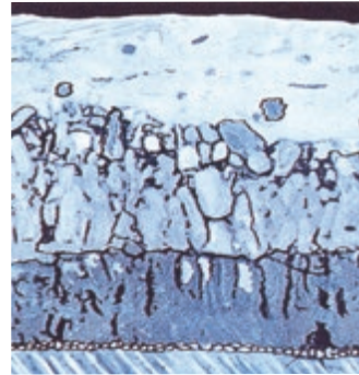
Schliffbild eines Zinküberzuges, ca. 200:1
